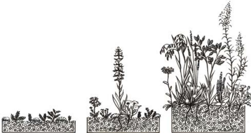
Abbildung 2: Gestaltungsprinzip für Dachbegrünungen in Abhängigkeit von der Profilhöhe, Quelle: Stephan Brenneisen
